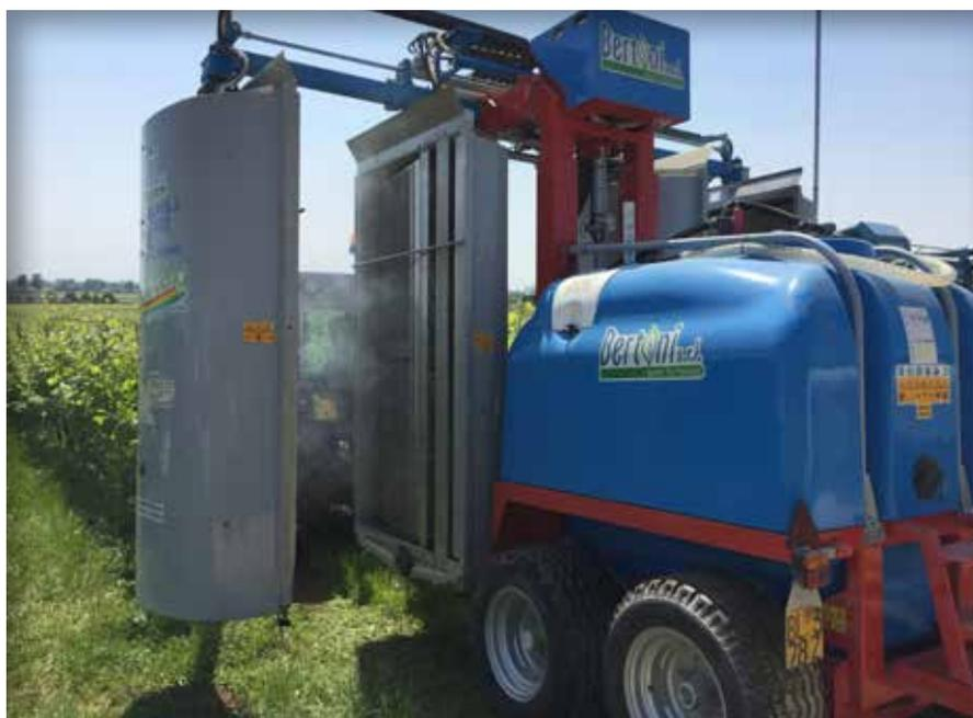
I dispositivi di **controllo automatico di posizionamento** dei pannelli rendono agevole l'imbocco dei filari
